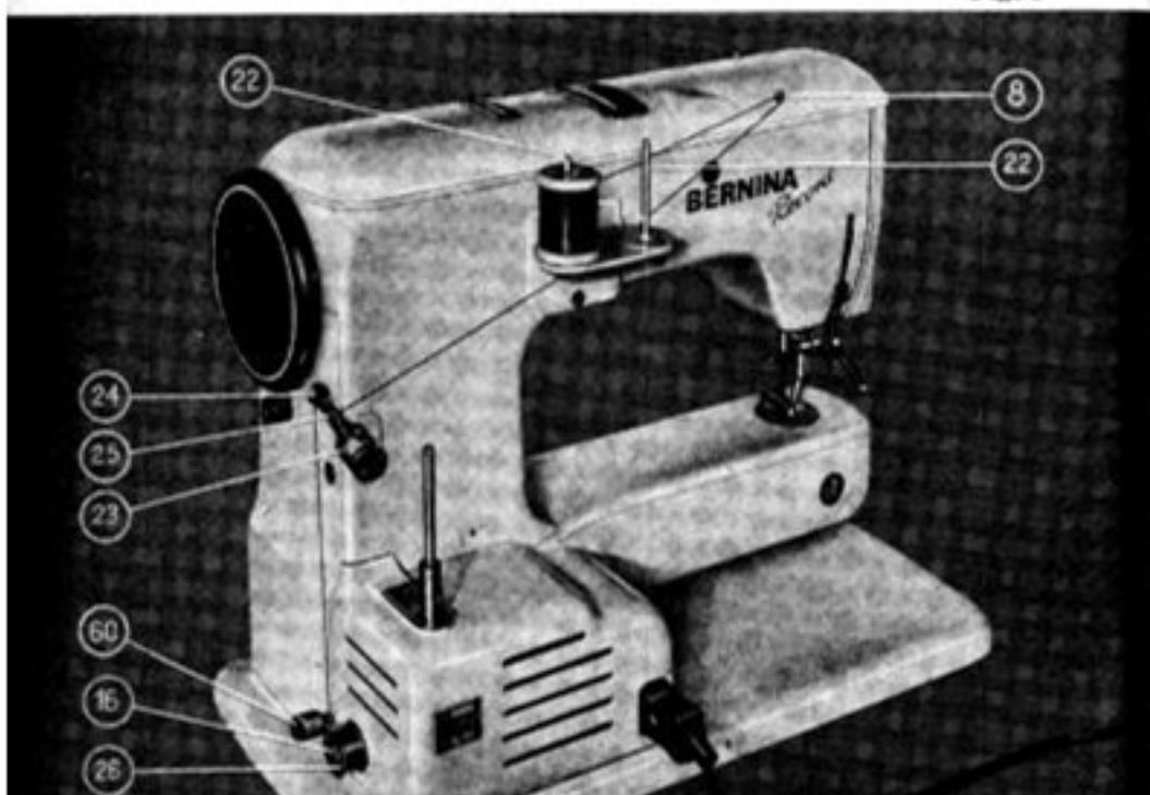
26 sur le bout d'arbre 16 sortant du carter du moteur et la tourner lentement jusqu'à ce que le petit cran d'arrêt de cet arbre s'engage dans la fente de la canette. Ce cran assure l'entraînement de la canette. En glissant la canette sur le bout d'arbre 16, on débraye en même temps automatiquement le mécanisme de la machine.
