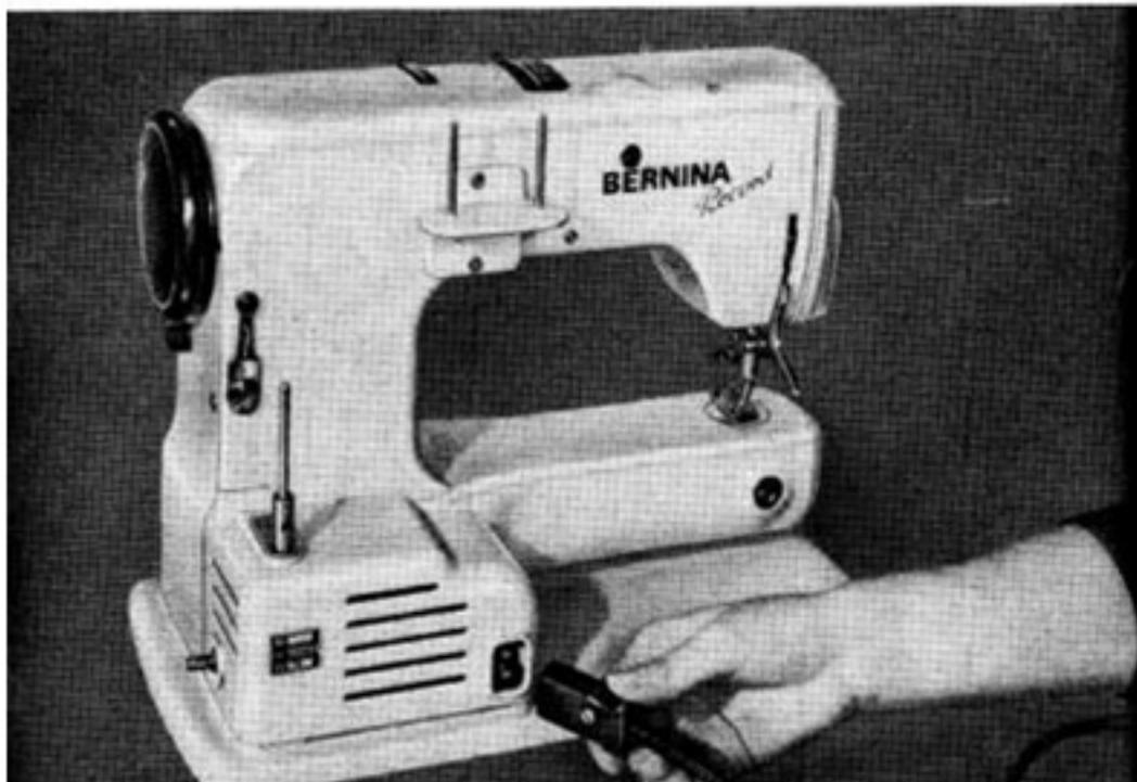
Une fois le moteur raccordé au réseau lumière par le câble, la machine est mise en marche par une légère pression du genou sur la genouillère. Plus on pousse la genouillère vers la droite, plus la machine tourne vite. Exercer le réglage de la vitesse quelques fois sans fil dans la machine.
