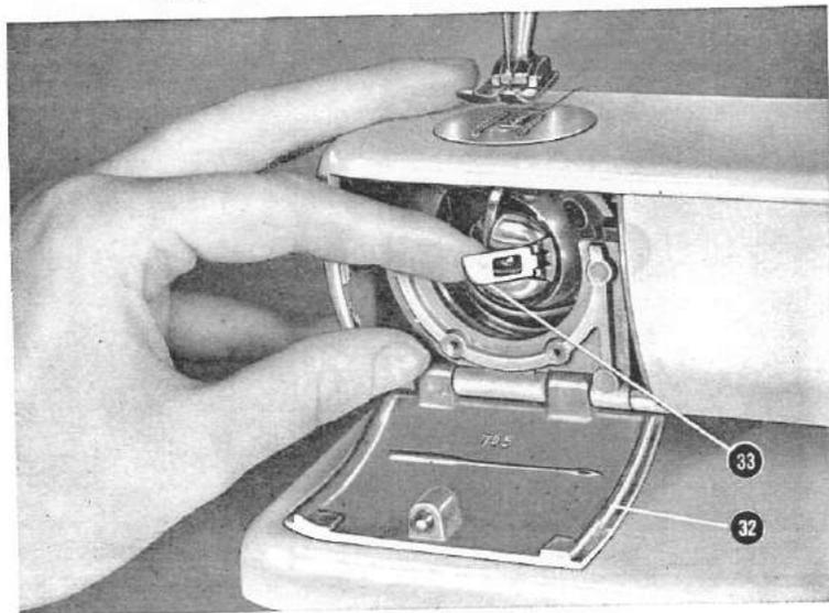
avec l'index de la main droite, ce qui donne accès au crochet-navette. On peut alors ouvrir le loquet 33 avec l'index gauche et sortir la navette avec la canette (fig. 6). Quand on lâche le loquet 33, la canette est libérée et sort de la navette.
